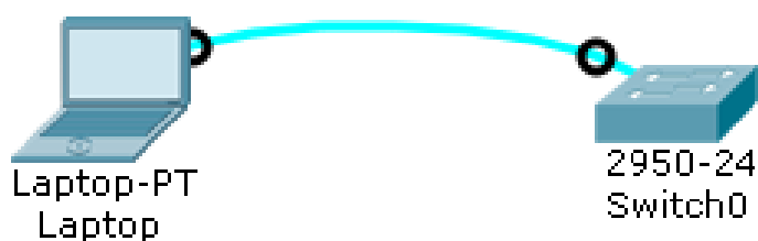
Рис. 2.5. Подключение консольного кабеля в Cisco Packet Tracer
